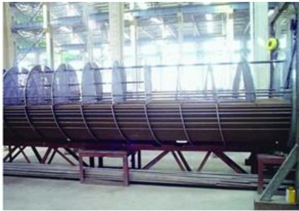
图为高效螺旋折流板换热器
